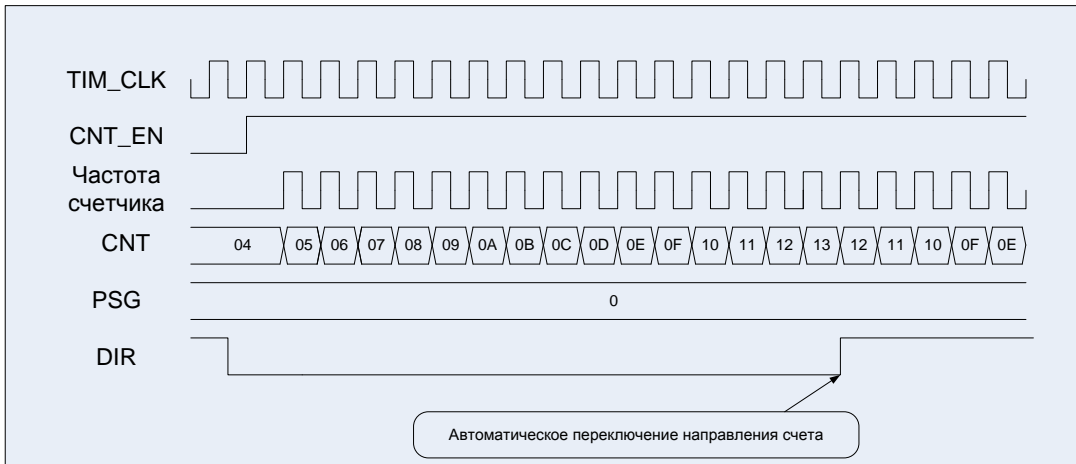
Рисунок 66 – Диаграммы работы таймера, счет вверх/вниз, сначала вверх
