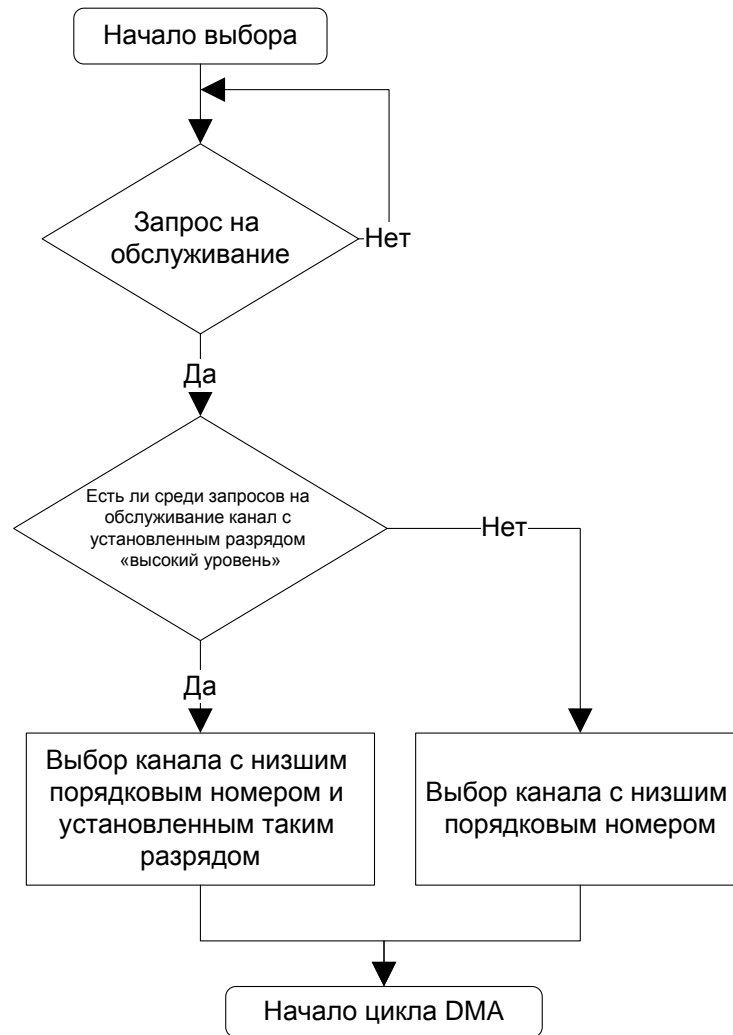
Рисунок 128 – Алгоритм выбора следующего канала для обслуживания
