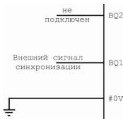
Рисунок 3.12 – Конфигурация при тактировании от внешнего генератора
