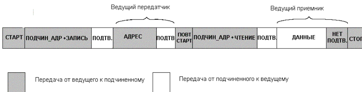
Рисунок 3.92 – Сочетание нескольких режимов TWI для обмена данными с последовательным ЭСППЗУ
