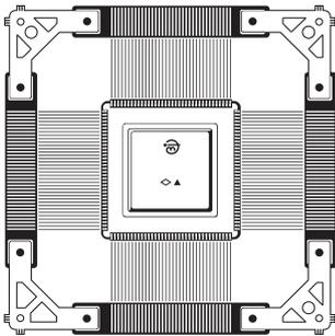
**32-разрядный микроконтроллер, специализированный под задачи управления электроприводом**
