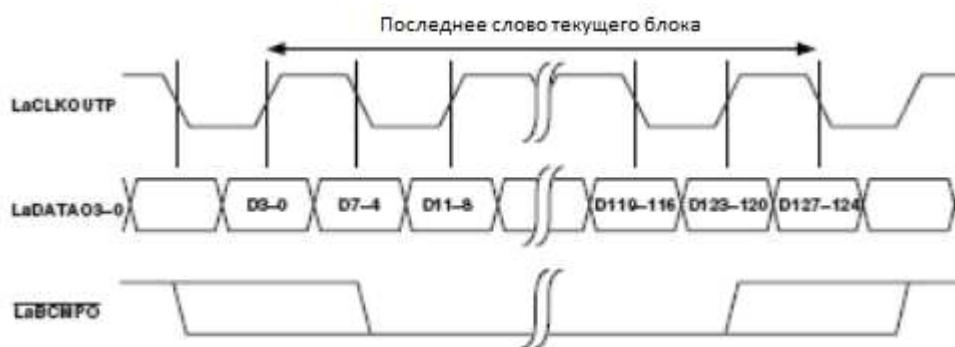
Рисунок 52 – Порт связи “а” передает порту связи “b” с завершением блока
