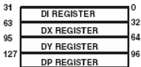
Рисунок 39 – блока управления передачей DMA
