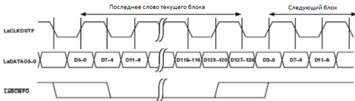
Рисунок 53 – Порт связи “а” передает порту связи “б” с завершением блока (новый блок из порта связи “а” следует немедленно после завершения первого блока)
