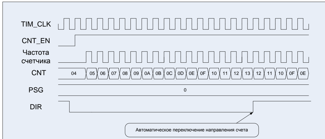
Рисунок 65 – Диаграммы работы таймера, счет вверх/вниз, сначала вверх
