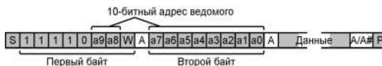
Рисунок 17.10 – Передача данных ведомому с 10-битным адресом (для расшифровки обозначений, применяемых на рисунке, следует обратиться к таблице 17.1)
