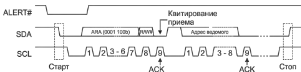
Рисунок 17.9 – Передача адреса отклика на сигнал предупреждения
