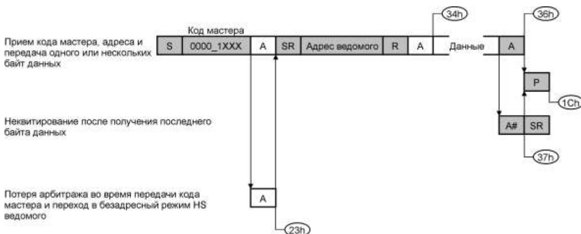
Рисунок – 17.23 – Режим HS ведомого передатчика
