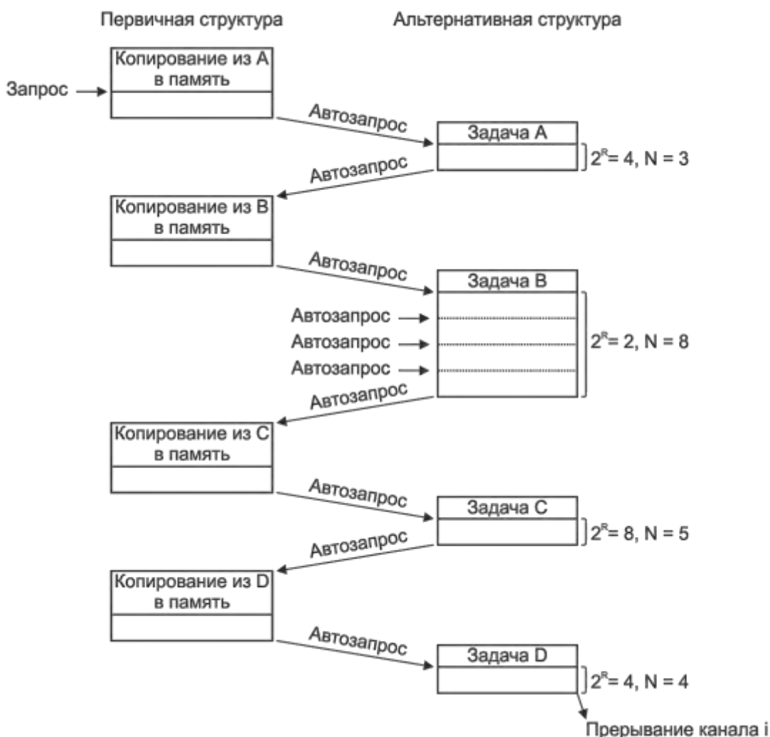
Рисунок 8.4 – Пример функционирования контроллера в режиме «разборка-сборка»
