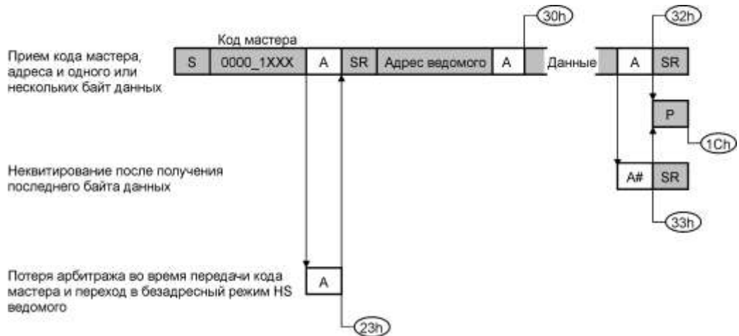
Рисунок 17.21 – Режим HS ведомого приемника
