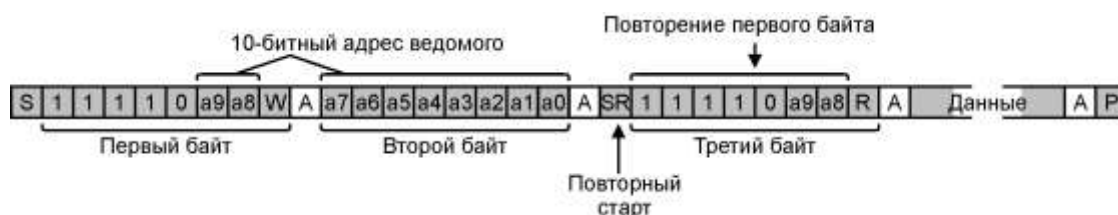
Рисунок 17.11 – Получение данных от ведомого с 10-битным адресом
