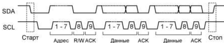
Рисунок 17.8 – Передача данных с 7-битной адресацией
