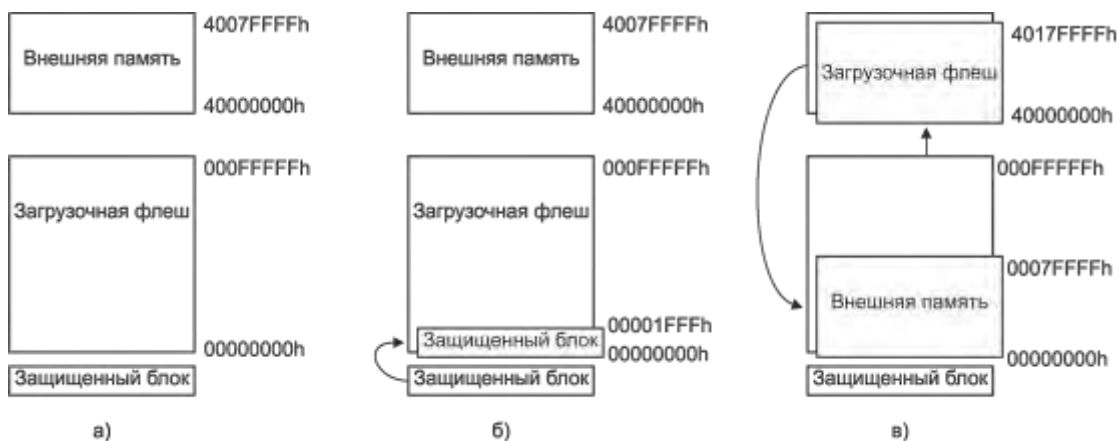
Рисунок 7.10 – Процесс мапирования при загрузке микроконтроллера (указанные диапазоны адресов соответствуют реальным объемам памяти микроконтроллера)
