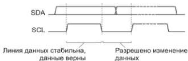
Рисунок 17.1– Передача бита данных
