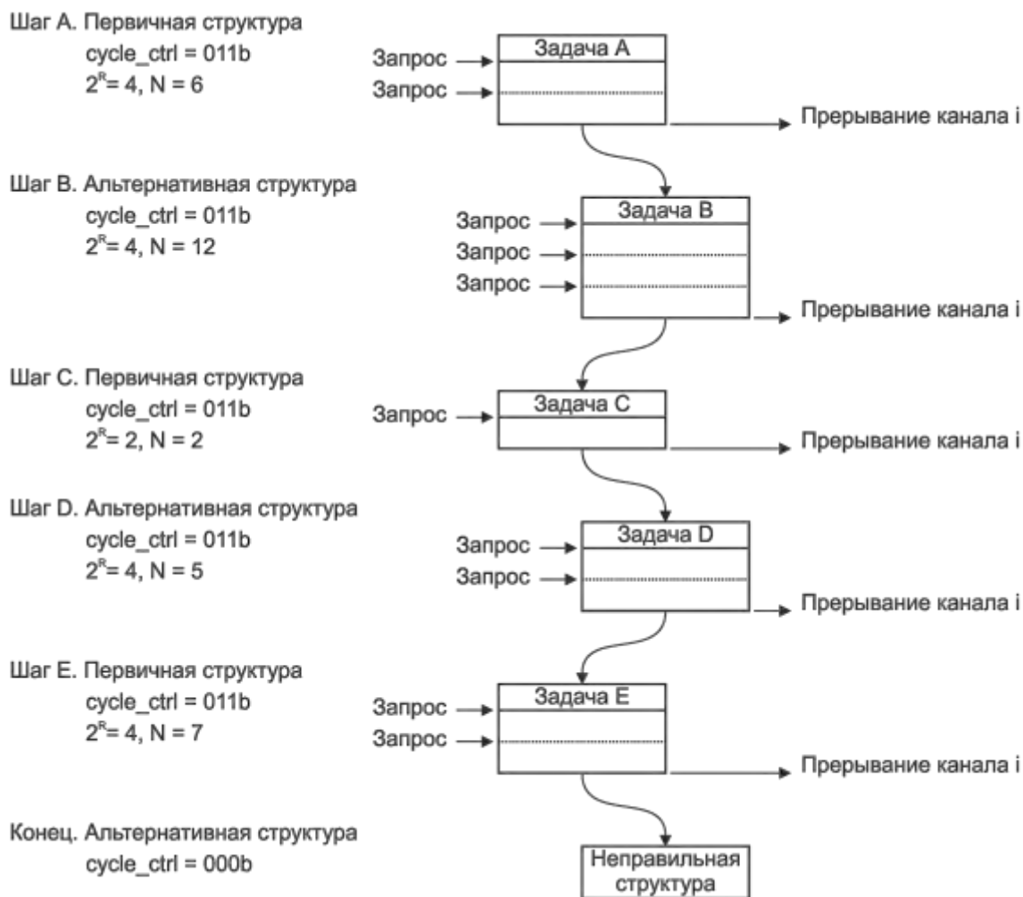
Рисунок 8.3 – Пример функционирования контроллера в режиме «пинг-понг»
