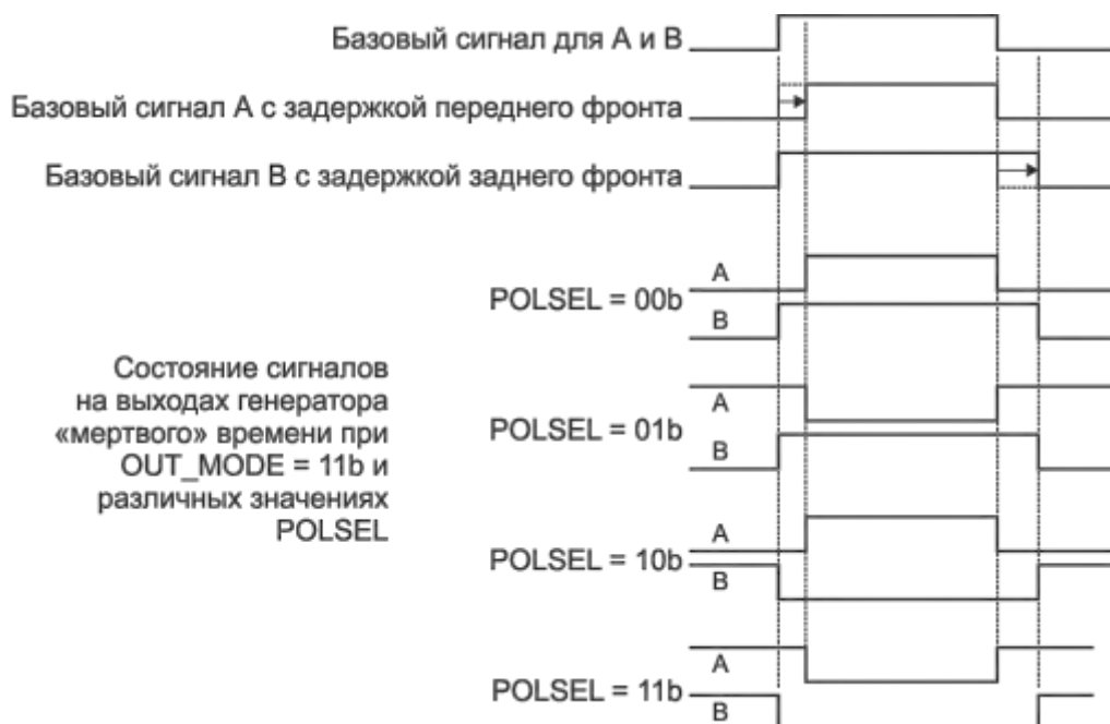
Рисунок 14.13 – Временные диаграммы работы генератора «мертвого» времени в типовой конфигурации
