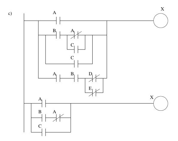
$$A + (\overline{B} + \overline{C} + \overline{D}) \cdot (B + \overline{C}) + A \cdot B \cdot (\overline{C} + \overline{D})$$
