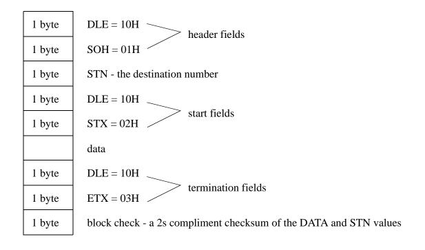
*Figure 28.12* The Basic DH+ Data Frame
