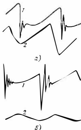
Рис. 6.6. Осциллограммы переменной составляющей выходного напряжения высокочастотного двухзвенного преобразователя постоянного напряжения при различных типах выходных сглаживающих фильтров и частотах выпрямляемого напряжения
