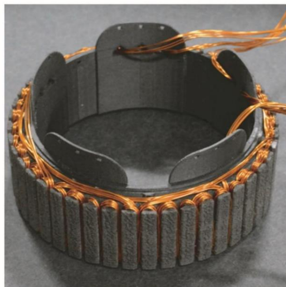
Рисунок 40. Окончательный прототип двигателя с приводом от обода, созданный собственными силами Национального управления по авиации и исследованию космического пространства (НАСА).
