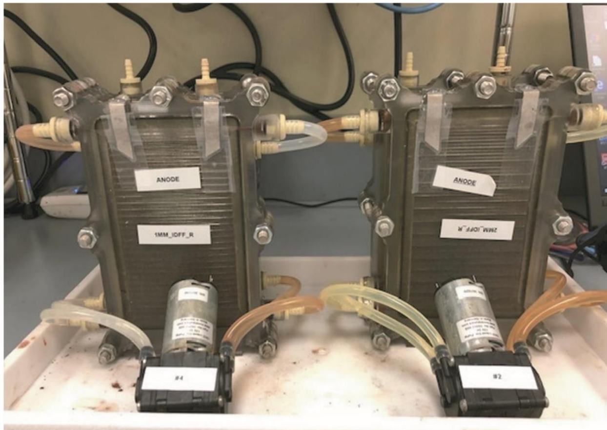
Рисунок 30. Модернизированные наноэлектропитательные проточные ячейки во время испытаний на герметичность (июль-август 2020 г.).
