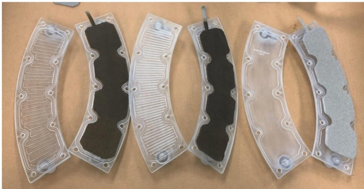
Рисунок 25, (слева) непокрытые пористые никелевые ячейки; и (справа) ячейка с полимерным покрытием. Также показаны три различных варианта конструкции поля потока: чередующееся, змеевидное и открытое поле потока.
