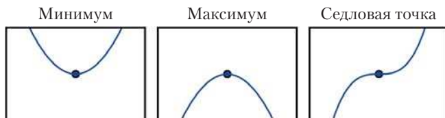
Рис. 4.2 ❖ Типы критических точек. Примеры трех типов критических точек в одномерном случае. Критической называется точка с нулевым угловым коэффициентом. Это может быть локальный минимум, в котором значение функции больше значений в окрестных точках, локальный максимум, в котором значение функции меньше значений в окрестных точках, или седловая точка, в которой значение функции может быть как больше, так и меньше значений в окрестных точках
