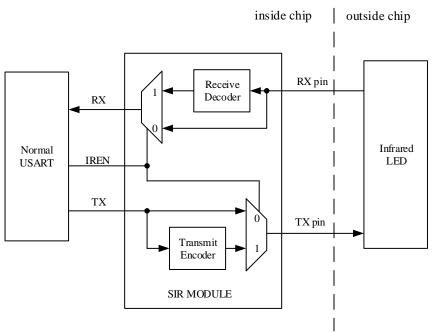
Figure 16-13. IrDA SIR ENDEC module
